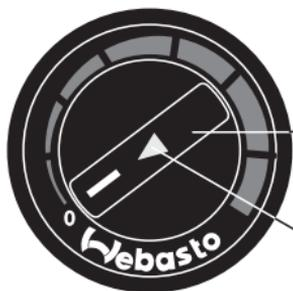
**!** Einstellungsänderungen am Bedienelement werden mit zeitlicher Verzögerung ausgeführt
