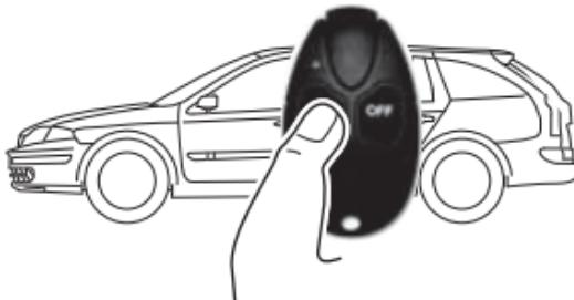
Efter udløb af den valgte tilkoblingstidafbrydes overførslen af tilkoblingssignalet til varmeapparatet, og den igangværende funktion (parkeringsvarme eller parkeringsventilation) afsluttes automatisk.
