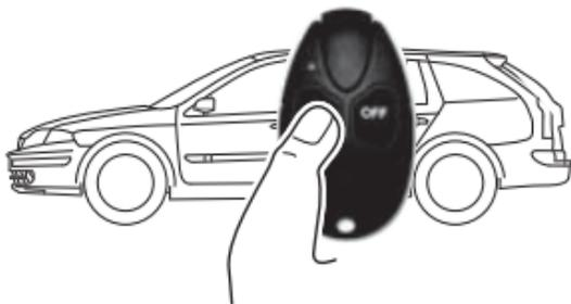
När vald inkopplingstid har gått ut avbryts överföringen av inkopplingssignalen på värmaren och pågående funktion (parkeringsvärmare eller parkeringsventilation) avslutas automatiskt.
