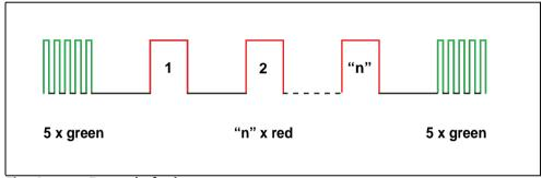
Fig. 4 Example fault message
