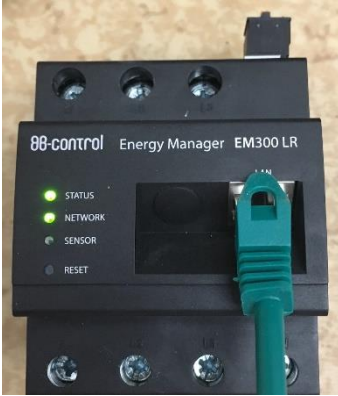
Modbus B-Control EM300-LR
