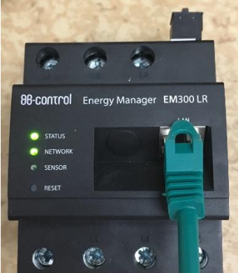
Modbus B-Control EM300-LR
