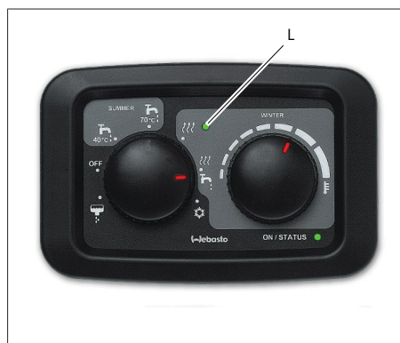
Fig. 5 Señal de falta de agua
