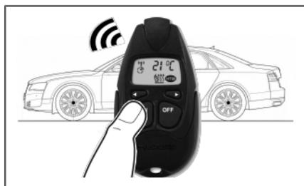
En fonction de la température de l'habitacle du véhicule et du niveau de confort sélectionné, la gestion du temps de chauffage (HTM, gestion du temps de chauffage) calcule le temps de chauffage ainsi que l'heure d'enclenchement de l'appareil de chauffage. Tenez compte des possibilités de réglage décrites ci-dessous.
