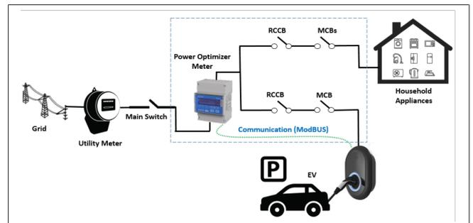
Der Leistungsoptimierer-Zähler muss direkt *nach* dem Hauptschalter installiert werden, siehe obige Abbildung.
