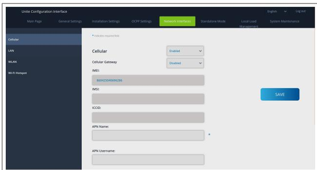
Bevor Sie die Mobilfunkverbindung aktivieren, müssen Sie eine SIM-Karte in den SIM-Kartensteckplatz einlegen (siehe Kapitel 6.14.1, "Anschluss von OCPP über das Mobilfunknetz (optional)" auf Seite 18).
