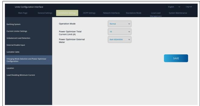
Bei Power Optimizer External Meter (Externer Zähler Leistungs-optimierer) muss der installierte externe intelligente Zähler aus der Dropdown-Liste ausgewählt werden.
