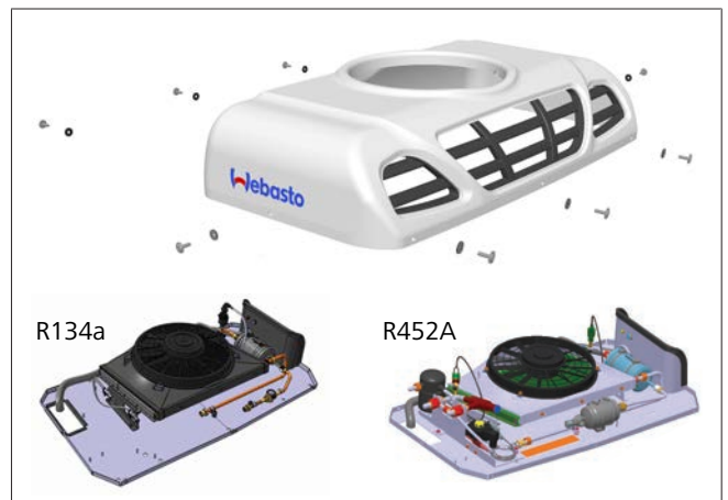
Abb. 32 Abdeckung des Frigo Top Verflüssigers anbauen
