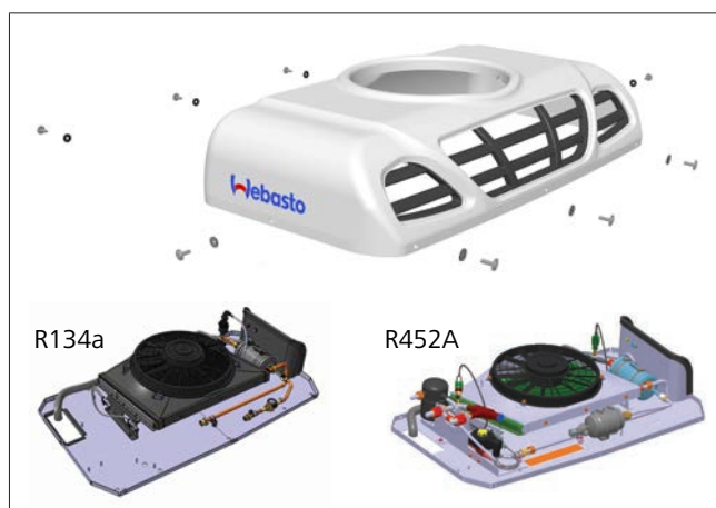
Fig. 32 Placez le couvercle du condenseur Frigo Top
