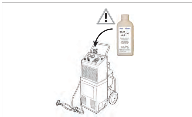
Fig. 16 Añada la cantidad adecuada de lubricante
