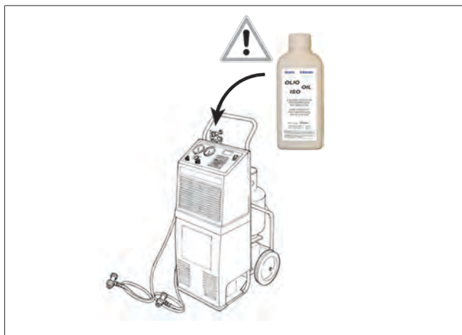
Abb. 16 Korrekte Schmiermittelmenge zugeben
