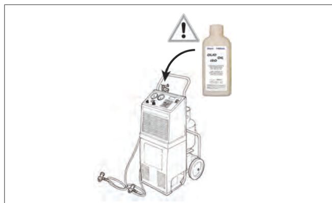
Fig. 16 Añada la cantidad adecuada de lubricante
