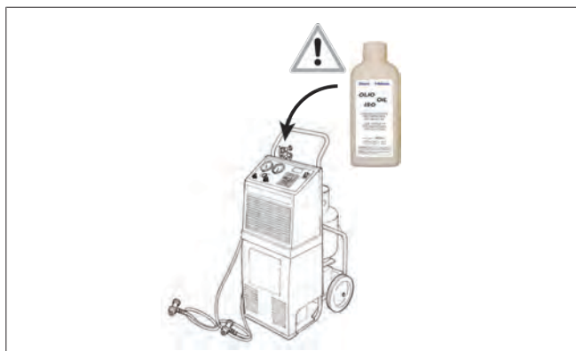
Abb. 16 Korrekte Schmiermittelmenge zugeben
